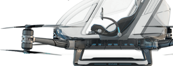
تاکسی های پرنده برقی این شرکت موسوم به "EHang ۲۱۶" دارای هشت بازو در حالت اتانک استقرار مسافر است که هر کدام، دو ملخ دارند.
